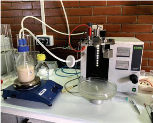
Encapsulator B-395 Pro della Buchi che implementa una tecnologia ad estrusione per la produzione di microcapsule con vibrazione ad alta frequenza (vibration technology).
